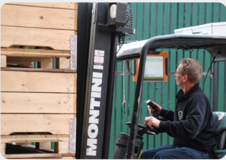
Chariot-élévateur équipé de lecteurs RFID et Windows terminal
