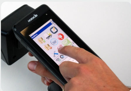
scanning van de tags gebeurt via een RFID handheld met gebruikersvriendelijke beheerssoftware
