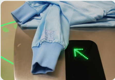
Aucxis bepaalde de optimale positie van de laundry tag op de cleanroomkledij voor een optimale scanning.
