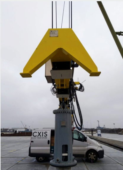
Installatie van de RFID-antennes en readers op de pontonkraan.
