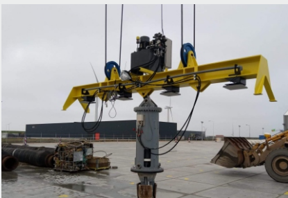
De RFID-antennes en readers op de verschillende kranen lezen de informatie van de getagde betonblokken.
