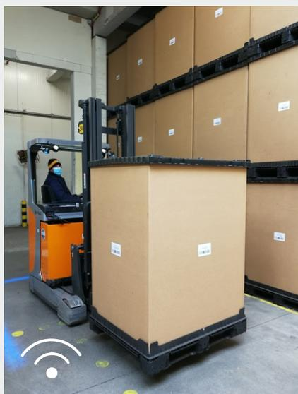
Dans l'espace de stockage, les puces incorporées dans le sol et les étiquettes RFID des colis sont lues par le kit matériel ATLAS qui est intégré dans les chariots élévateurs.
