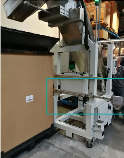
Les stations de remplissage et les convoyeurs à chaîne correspondants qui transportent les colis servent de points de détection RFID fixes et sont équipés de lecteurs et d'antennes RFID.
