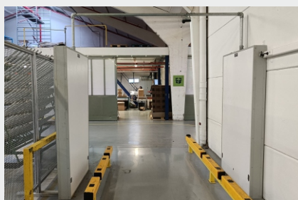
Deze RFID-gate registreert welke laarzen op welke kar liggen zodat de inpakverantwoordelijke alles vlot en correct kan inplannen.
