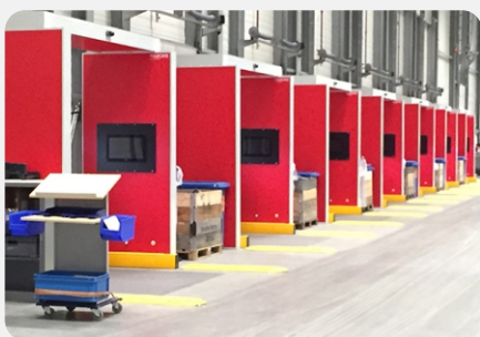
12 RFID-portalen detecteren in- en uitgaande meubelstukken
