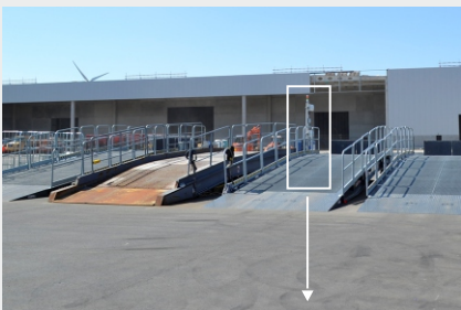
Un portique RFID mobile enregistre les machines qui entrent les conteneurs maritimes métalliques.
