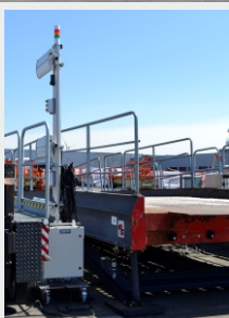
Un portique RFID mobile enregistre les machines qui entrent les conteneurs maritimes métalliques.
