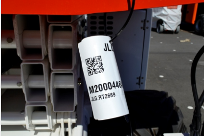
Les étiquettes RFID sont attachées avec des sangles et contiennent les informations sur le produit et un code QR.
